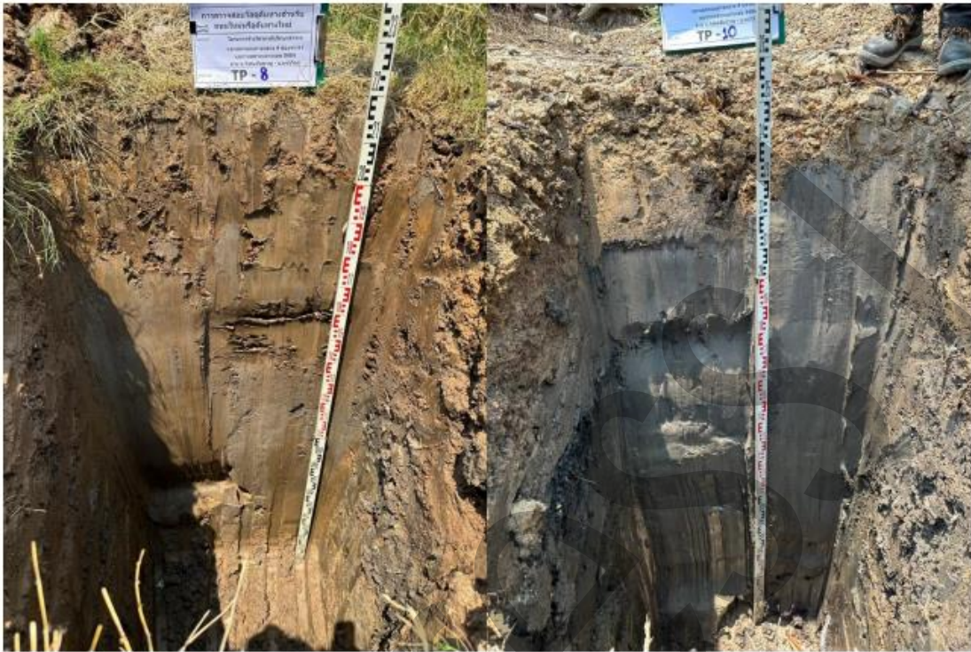
รูปที่ 6.1-2 แสดงรูปตัวอย่างการขุดหลุมสำรวจชั้นดินในสนาม
